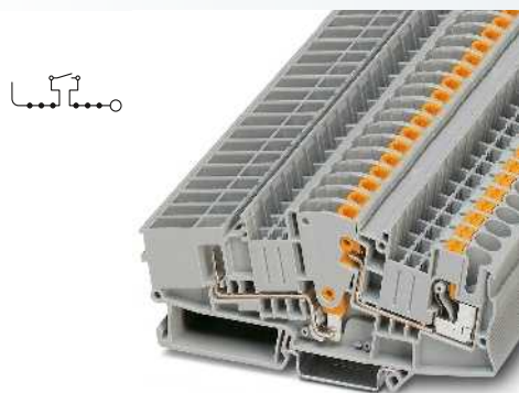
6 (10) мм 2 , 30 А, клемма с размыкателем для трансформатора тока, для штекера короткого замыкания
