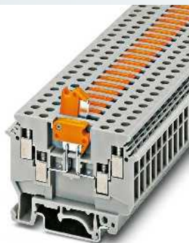
4 (6) мм 2 , 16 А, клемма с ножевым размыкателем, 4 контакта, с тестовым гнездом в винте
