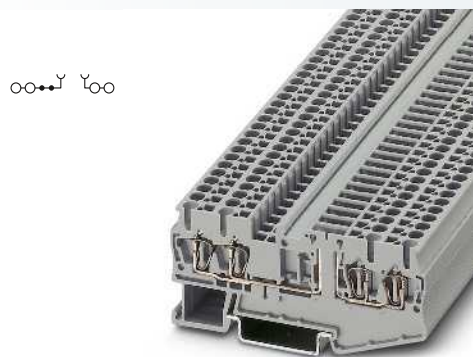
2,5 (4) мм 2 , 20 А, разделительная клемма, 4 контакта
