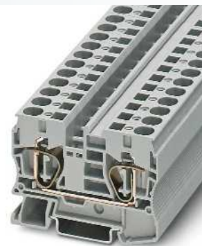
10 (16) мм 2 , 65 А, проходная клемма
