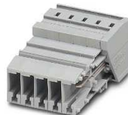
4 (6) мм 2 , 32 А, разъем сопряжения, от 2 до 15 контактов
