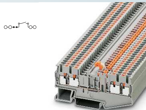
2,5 (4) мм 2 , 20 А, клемма с ножевым размыкателем, 4 контакта
