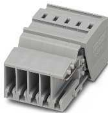
2,5 (4) мм 2 , 24 А, разъем сопряжения, от 2 до 15 контактов
