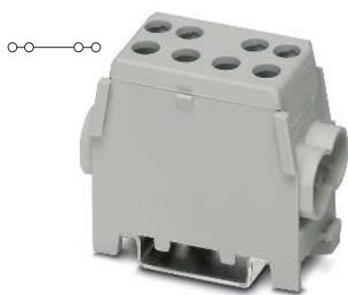
35 (35) мм 2 , 125 А, распределительная клемма для основной линии, 2 отвода по 25 мм 2
