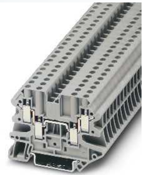
4 (6) мм 2 , 39 А, проходная клемма, 4 разъема
