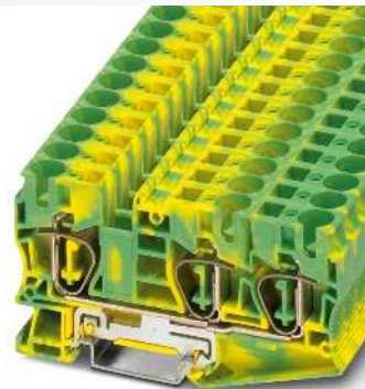
10 (16) мм 2 , 70 А, заземляющая клемма, 3 контакта
