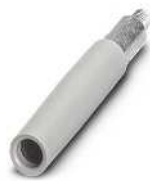
Тестовое гнездо, 4 мм, для клемм с размыкателем измерительных трансформаторов SRTK 6 и URTK 6, резьба M3
